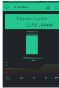
Gambar 12. Tampilan Antarmuka Aplikasi Blynk yang Menampilkan Kondisi Air di Teko Habis
