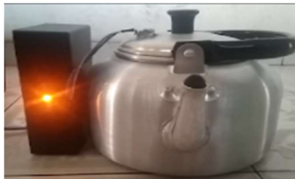
Gambar 10. LED Indikator Kuning Kondisi Air di Teko Tinggal Separuh
