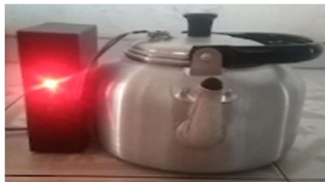
Gambar 11. LED Indikator Merah Kondisi Air di Teko Sudah Habis
