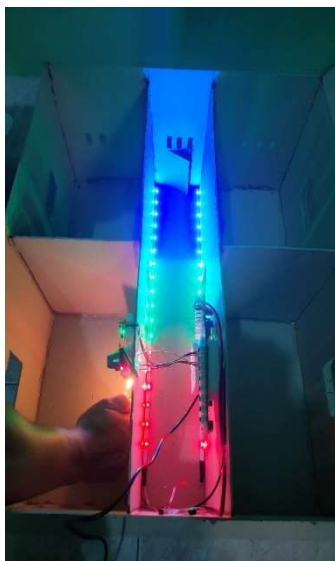
Gambar 13. Penerapan Tampak Atas Kondisi Uji Coba Sensor Api
