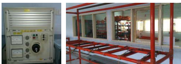
Gambar 16. Pelaksanaan Uji Isolasi tegangan tembus Temporary Insulator di LAB UPDL Semarang
