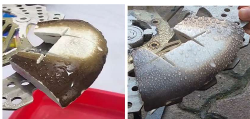
Gambar 7 Uji simulasi hujan pada permukaan isolator, 7a kiri: sebelum coating, 7b kanan: sesudah coating
