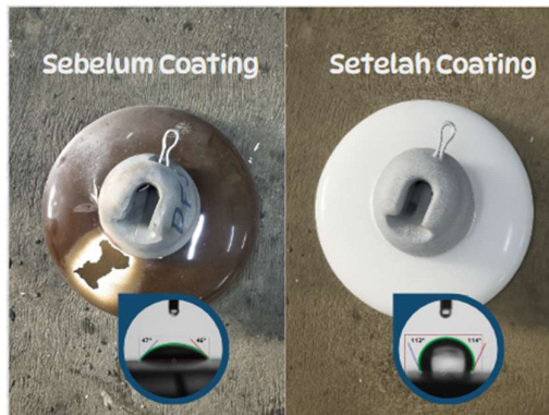
Gambar 10 Perbedaan Isolator Keramik, 10a kiri: Sebelum coating 10b kanan: Sesudah Dilapisi coating
